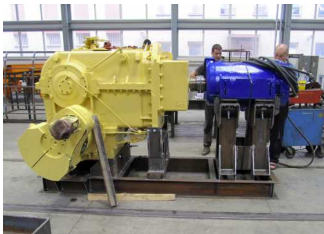
Montáž nového elektromotoru s převodovkou.
